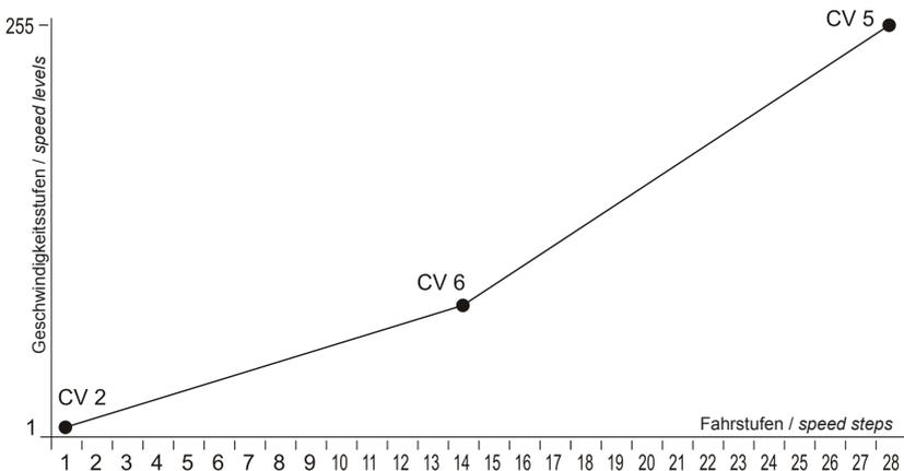
Wenn CV 6 auf Null gestellt ist, wird die Berechnung der Kennlinie ohne diesen Wert ausgeführt, d. h. nur zwischen den Werten CV 2 und CV 5. Ansonsten sollte ein Wert zwischen der Anfah- und Maximalgeschwindigkeit eingestellt werden. Dieser Modus ist aktiv, wenn in CV 29 das Bit 4 gelöscht ist (Abb. 2).
